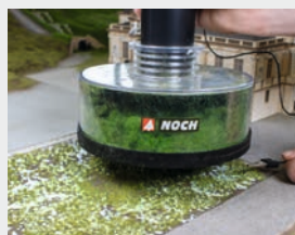
Große Flächen werden so zügig beflocht, ohne, dass Gras nachgefüllt werden muss.
