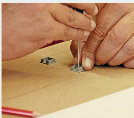
2. An den Schnittstellen der Fahrtrassen werden Bodenplatten für die Pfeiler aufgeschraubt.
