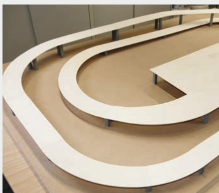
4. Die Gleistrasse ist nun fertig montiert.
