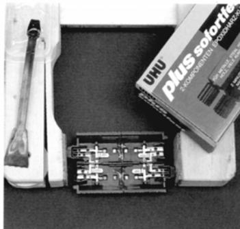
Die Fuge der beiden zusammengesteckten Paßstückteile verkleben wir mit einem schnellen Zweikomponentenkleber (in diesem Fall UHU plus sofortfest) und drücken die beiden Paßstückhälften bis zur Aushärtung mit einer Zwinde oder im Schraubstock zusammen
