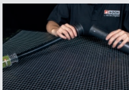
Der Detail-Beflocker wird auf den Gras-Master 4.0 gesteckt. Sicheres Einrasten durch Bajonettverschluss.
