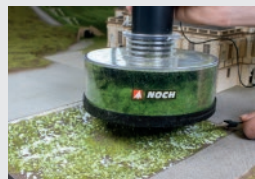
Große Flächen werden so zügig beflockt, ohne, dass Gras nachgefüllt werden muss.
