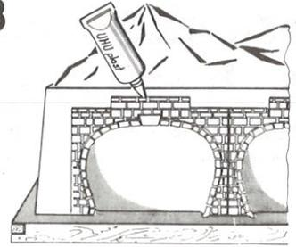
soweit vorgesehen an der Anlagenrückseite 2-gleisige Portale zur besseren Zugänglichkeit anbringen
