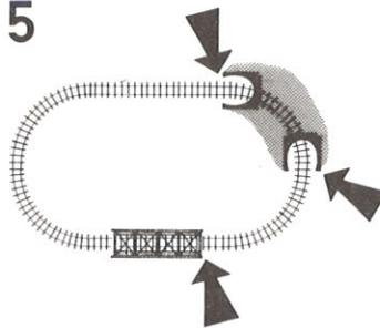
Gleise lose auflegen auf korrekte Lage an Portalen, Brücken etc. achten
