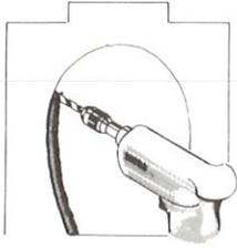
Portale mit Bohrmaschine und Fräsbohrer ausfräsen
